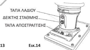
Τάπα αποστράγγισης περιβλήματος βάσης
